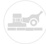
Виброуплотнение тротуарных плит следует производить виброплитой с широкой основой для равномерного распределения нагрузки на отдельных плитах. Уплотнение виброплитой с узкой основой при трамбовке одного края изделия может привести к их растрескиванию. Процесс уплотнения проводится до полного заполнения швов.
